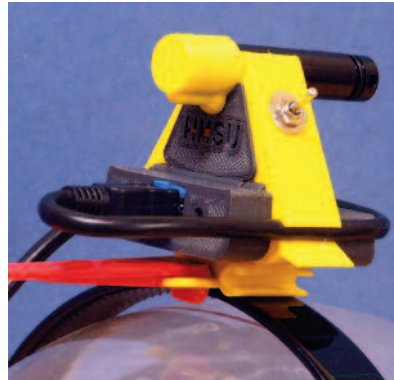
3 Die Messeinheit: Der ganz oben montierte Laser dient der Kalibrierung des Systems, damit der in der Messeinheit verbauter Goniometer eine Referenz für die erfassten Bewegungsdaten der Kopffrotation hat. Die Halterung für den Laser und den Goniometer wurde im 3D-Druck hergestellt.
